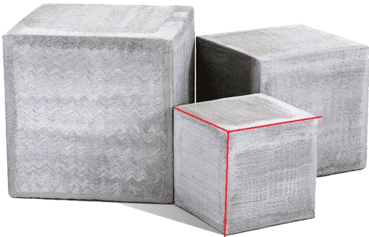
Бетонный куб со стороной 10 см
