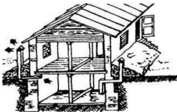
ПРУ в подвале
