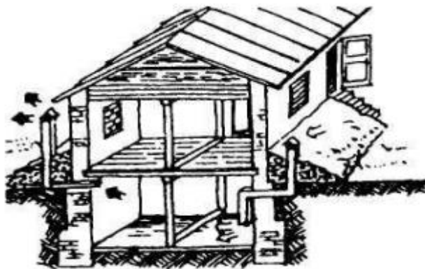
ПРУ в подвале
