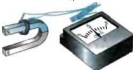
2. Наблюдая за показаниями миллиамперметра, подводите один из полюсов магнита к катушке, потом на несколько секунд остановите магнит, а затем вновь приближайте его к катушке, вдвигая в нее (рис). Запишите, возникал ли в катушке индукционный ток во время движения магнита относительно катушки; во время его остановки.
