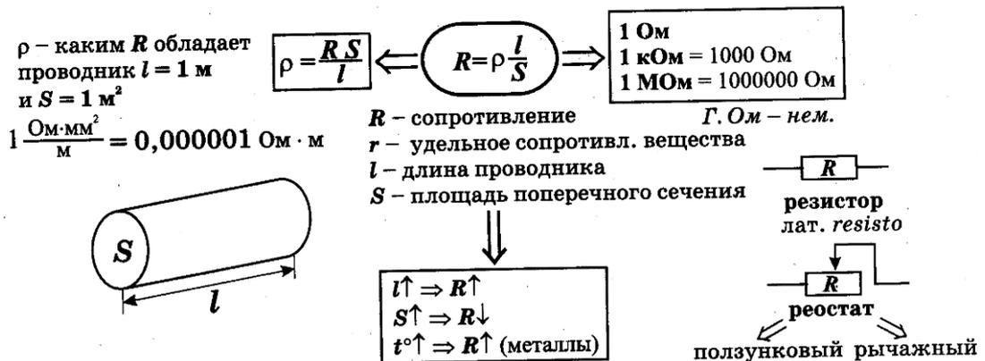
Удельное сопротивление меди  $\rho = 0,017 \text{ Ом}\cdot\text{мм}^2/\text{м}$ , что означает: медный проводник длиной 1 м, площадью поперечного сечения  $1 \text{ мм}^2$  имеет сопротивление  $0,017 \text{ Ом}$ .
