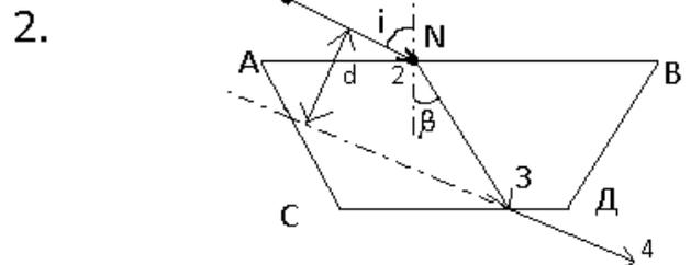
Коэффициент преломления – это отношение синуса угла падения светового луча к синусу угла преломления луча. Для данных двух сред коэффициент преломления – величина постоянная:
