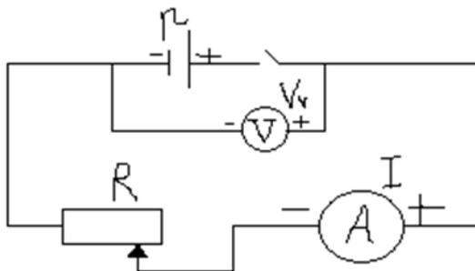
Практически ЭДС источника тока можно определить с помощью вольтметра подключенного непосредственно к полюсам источника по схеме 1.
